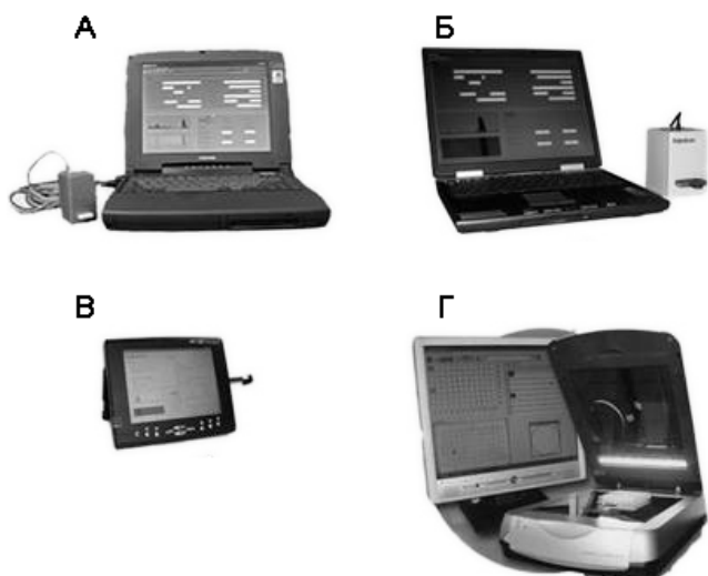
Рис. 1. Варианты регистрирующих устройств на основе видеоцифровой камеры: А — «Рефлеком-Мини»; Б — анализатор «Рефлеком»; В — «Рефлеком-компакт»; Г — на основе сканера: система «Эксперт-лаб»
